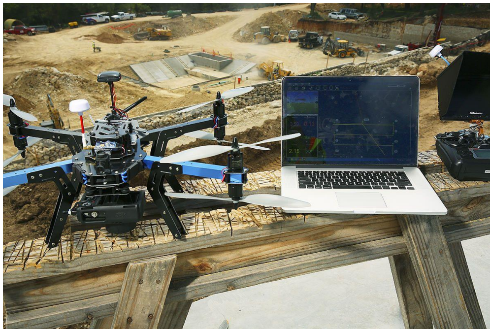
Рисунок 1. Дрон с мультиспектральной камерой для идентификации объектов без ухудшения радиометрических данных
